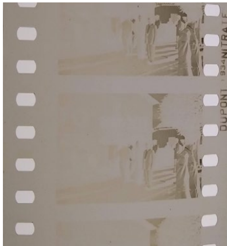
Figuras 57 e 58: Imagem descorada com predominância da cor magenta. E filme em P&B com baixo contraste entre as cores – esmaecido.
