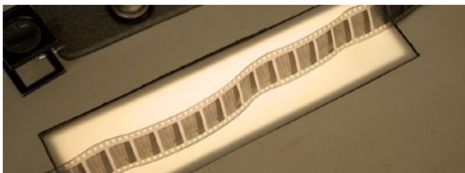
Figura 46: Filme com abaulamento acentuado.
