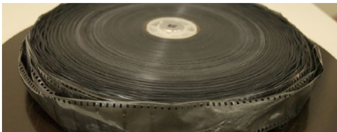
Figura 45: Filme ressecado, com abaulamento e pontos com estriamento da emulsão.
