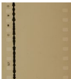
Figura 28: Negativo de som. Geralmente o suporte é transparente e a pista sonora na cor preta.
