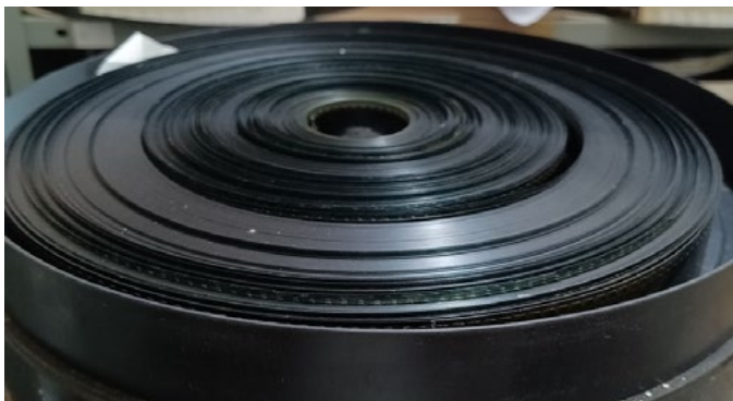
Figura 21: Filme com as espirais desalinhadas.
