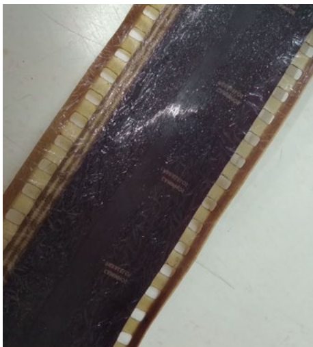
Figuras 48 e 49: Craquelamento acentuado, com formação de cristais. Na segunda imagem, os cristais reticularam formando falhas na imagem e destruindo-a quase completamente.
