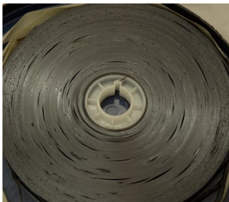
Figura 51: No último estágio de desplastificação o suporte de acetato de celulose empedra e se liquefaz.
