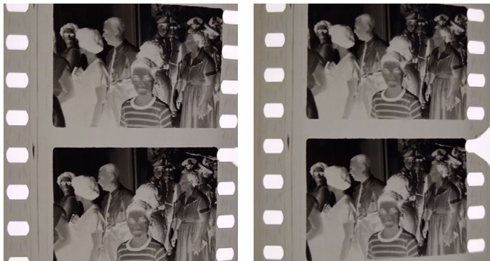
Figura 47: Perfurações rompidas podem ser arredondadas com tesoura de alta precisão a fim de evitar maiores danos ao filme. Este trabalho requer cuidado e atenção.
