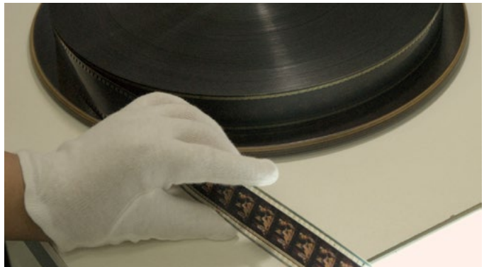
Figura 18: Ao analisar um filme na mesa enroladeira, não se deve tocar sua imagem e pista de som, segurando-o apenas pelas bordas.
