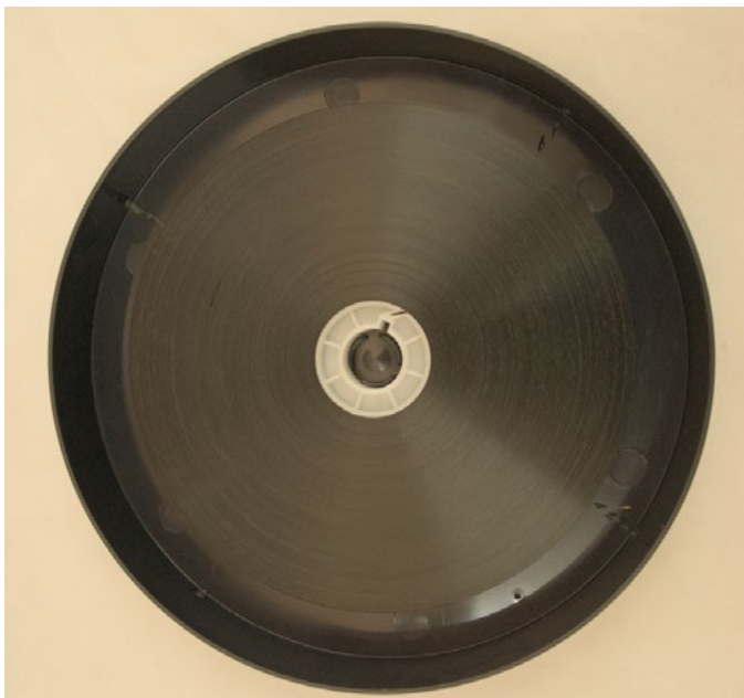
Figura 22: Filme com as espirais alinhadas.
