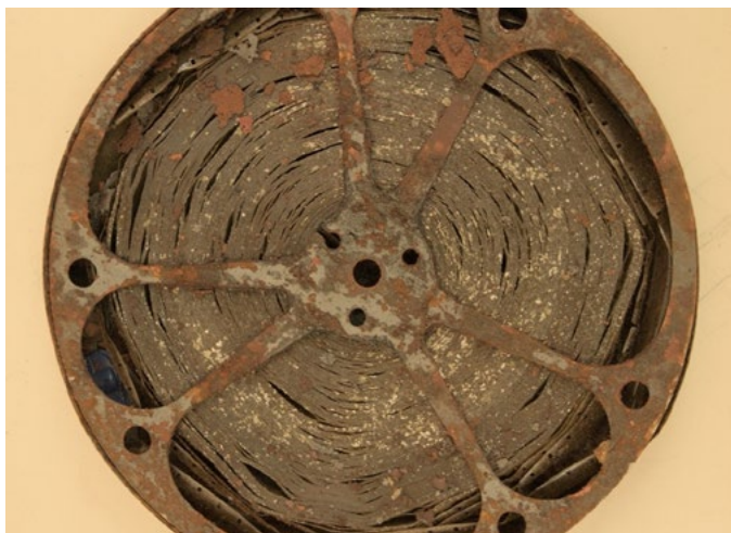
Figura 11: A ferrugem proveniente da lata contamina o filme e acelera sua deterioração.
