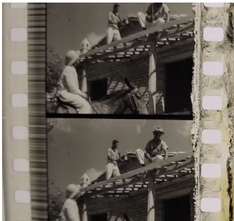
Figuras 52 e 53: A hidrólise inicia pelas bordas da película e pode destruí-la completamente.
