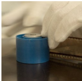
Figura 19: Prendendo o filme à fenda do batoque.
