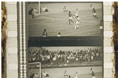
Figura 55: Os fungos iniciam o ataque pelas bordas e podem destruir a imagem e a pista de som.
