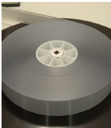
Figura 6: Filme não revelado, sem emulsão, para confecção de pontas de proteção.
