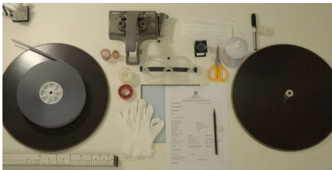
Figura 5: Mesa enroladeira horizontal e instrumentos mais utilizados na análise de filmes. (Sala de trabalho do MuseCom)
