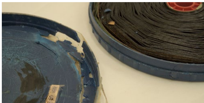
Figura 10: Estojos de plástico não inerte são menos estáveis e podem reagir química e fisicamente com os materiais intensificando os danos sobre as películas.
